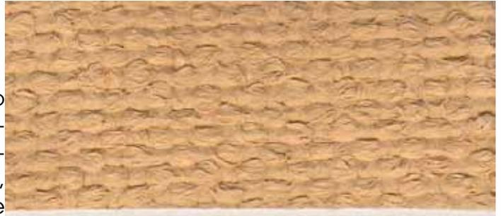
Cubierta de Protección contra cualquier elemento incandescente producido en la aplicación de Soldadura Eléctrica, Esmerilado de Soldaduras Eléctricas y/u otros Elementos que pudieran iniciar Flama, Incendio o Quemar Superficies con acabados de Tipo Especial.
