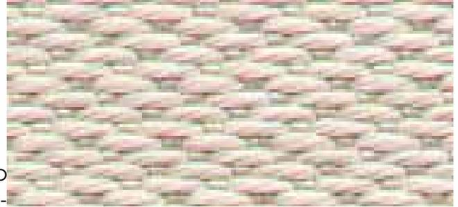
Cubierta de Protección contra cualquier elemento incandescente producido en la aplicación de Soldadura Eléctrica, Esmerilado de Soldaduras Eléctricas y/u otros Elementos que pudieran iniciar Flama, Incendio o quemar superficies con acabados de Tipo Especial.
