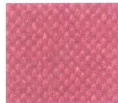
**Descripción:** La cubierta de protección Outfire® OB05 esta manufacturado con un textil de algodón tejido tipo TEFETAN reforzado tratado con poliuretano y resinas vinilo-acrílicas retardante al fuego y una capa de hule mineral por ambos lados. Se manufactura en color rojo oscuro.
